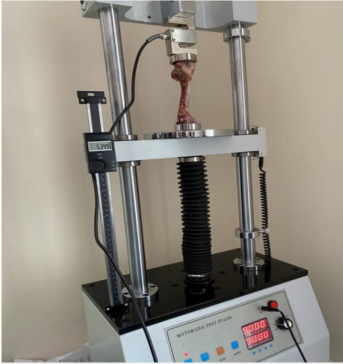
Şekil 2. Geratech SH 5000 test sistemi kullanılarak kuzu kemiğine aksiyel kuvvet uygulanması.
